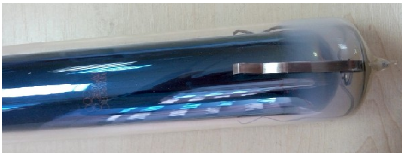
Вакуумная трубка с нарушенным вакуумом
