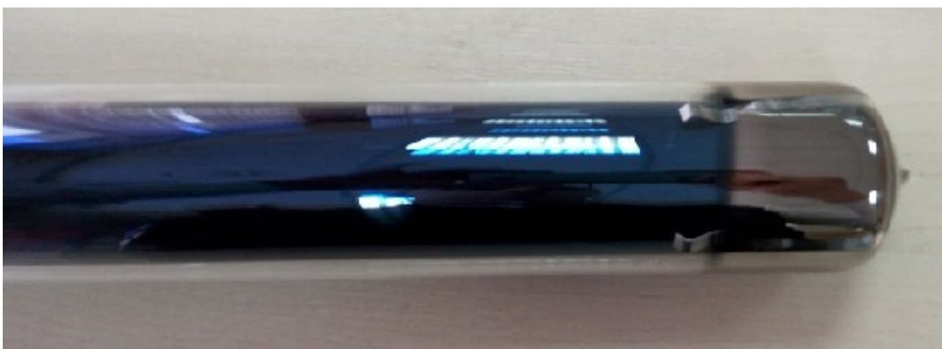
Вакуумная трубка с вакуумом в норме
