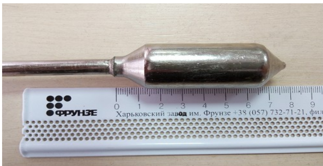
Вакуумная трубка вакуумного солнечного коллектора JX SPC (1),(2)
