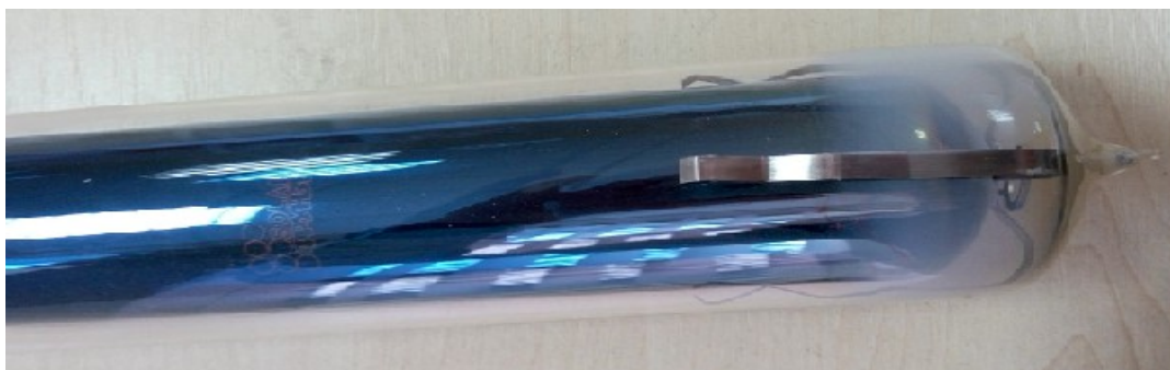
Рис. 18 - Вакуумная трубка с нарушенным вакуумом
